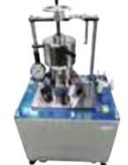
下金属との摩擦がなく、かつ等方的に圧力が作用するために、密度が均一で方向性の少ない成形体が得られます。
