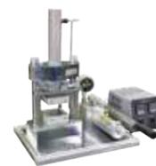
加熱成形用のダイセット方式の卓上ホットプレス機
