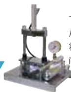
下部シリンダーからの加圧上昇だけで、金型がフローティング状態になる粉末の両軸成形機。
